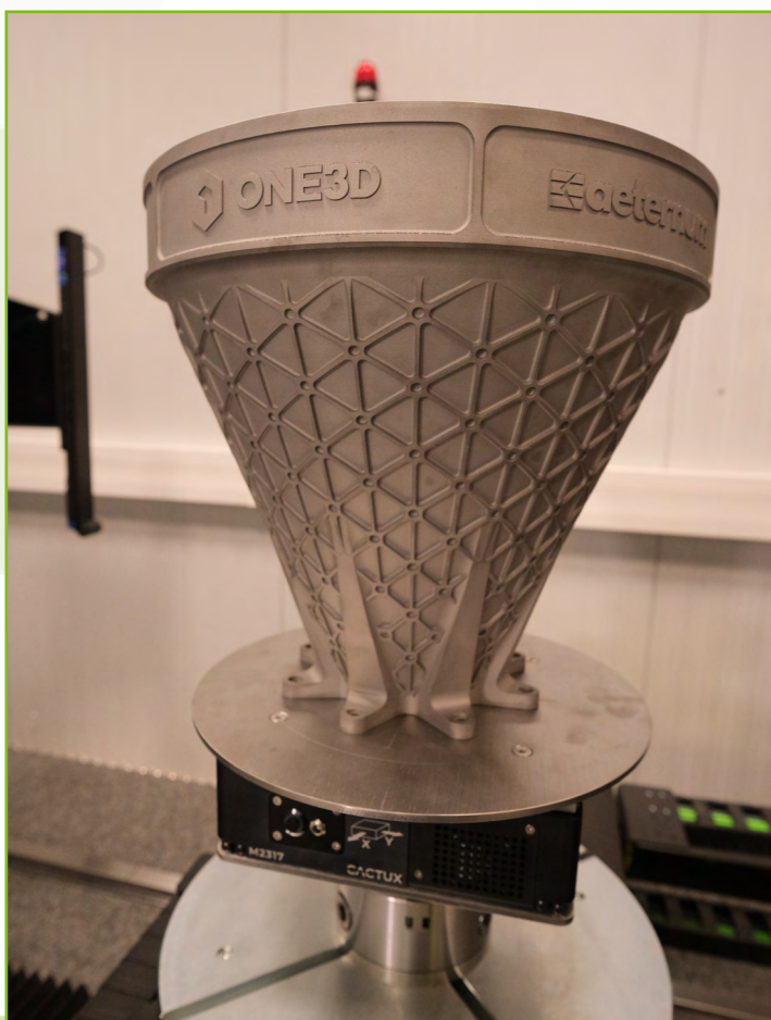
Obrázek 1: Foto aditivního dílu uvnitř CT systému.
