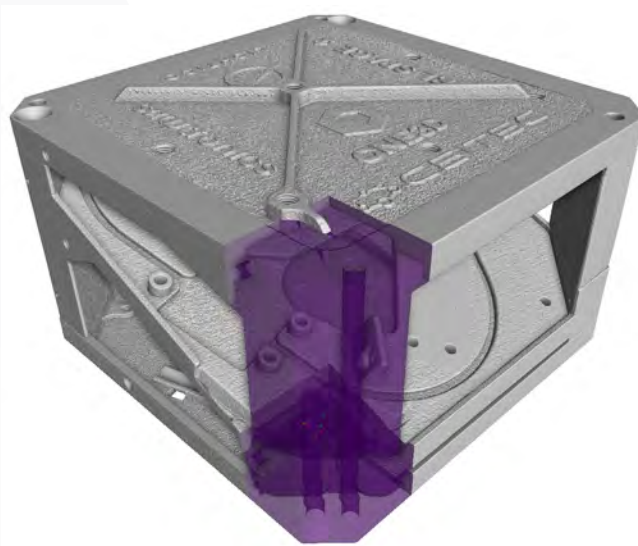
Obr. 2: 3D render tomografických dat LLD sestavy.
