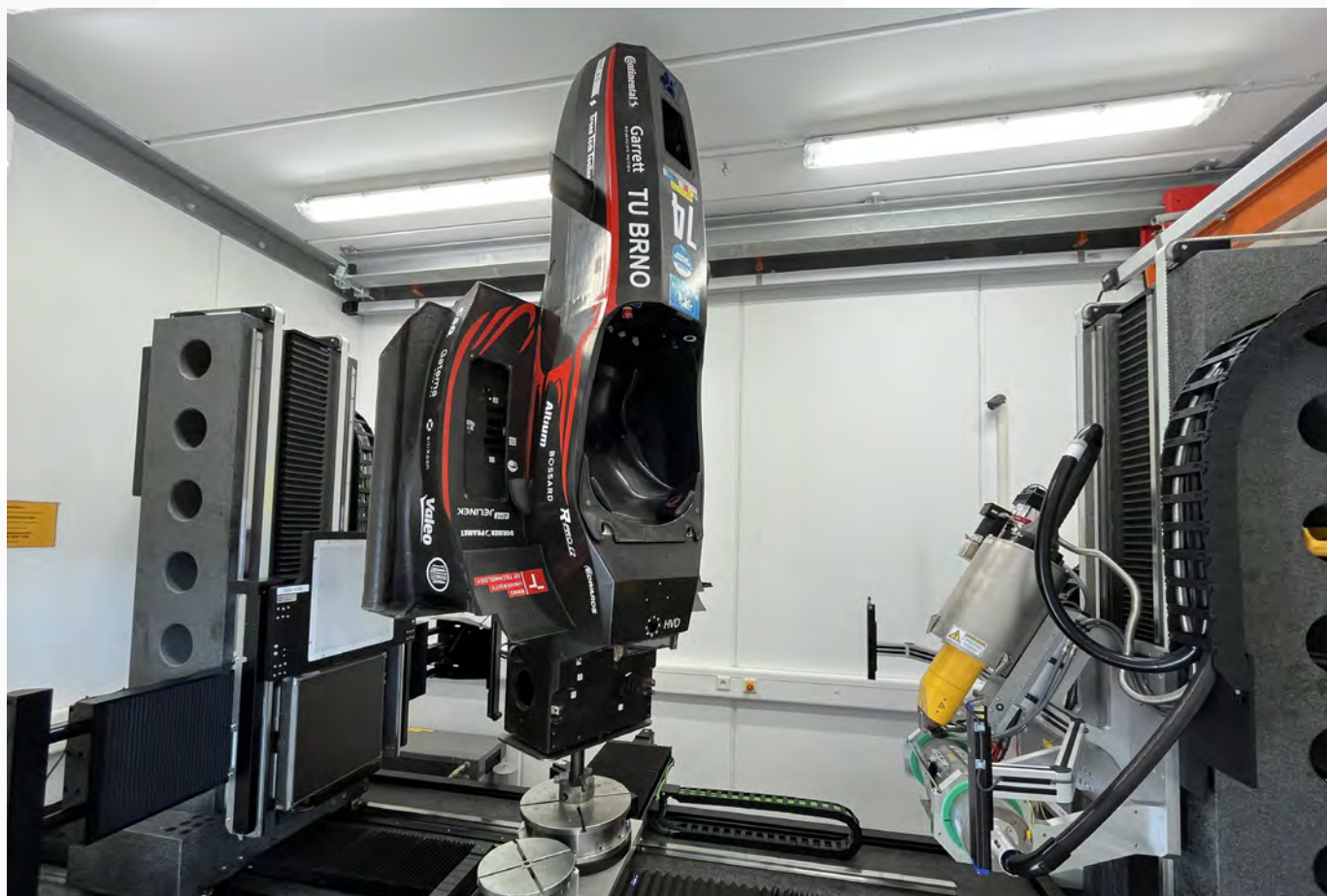
Obr. 5: Foto monokoku upnutého uvnitř tomografického systému.
