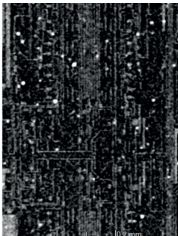
Obr. 11: Detail řezu z mikroCT systému (voxelové rozlišení 2,8 \mu\text{m} ).
